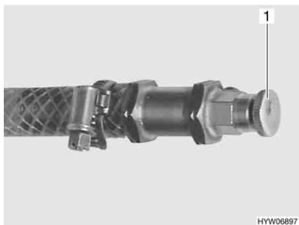
Fig. 195 Válvula de purga de la calefacción de agua caliente
