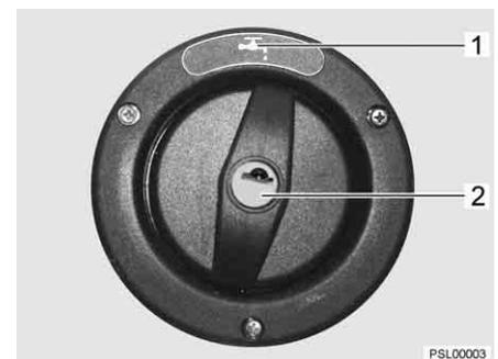
Fig. 147 Tubo de llenado de agua potable (alternativa)
