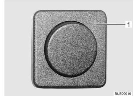
Fig. 42 Luz interior, interruptor de luz separado de la lámpara
