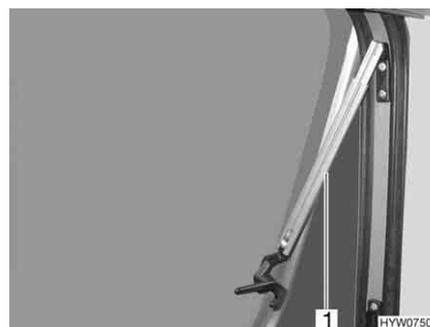
Fig. 50 Ventana abatible con soportes automáticos, abierta
