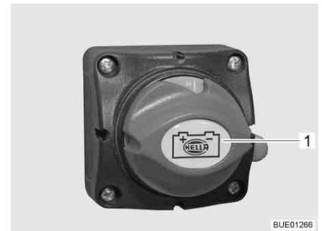
Fig. 89 Interruptor principal de la batería, posición "ON"
