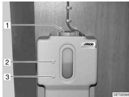
Fig. 194 Recipiente de compensación para la calefacción de agua caliente
