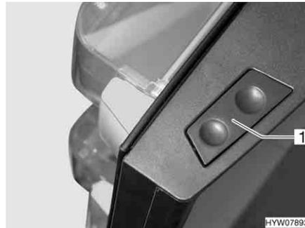
Fig. 140 Botón de desbloqueo de la puerta del frigorífico (Dometic de la serie 8)
