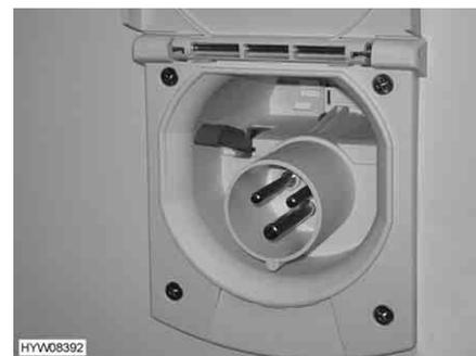
Fig. 95 Conexión de 230 V en el vehículo
