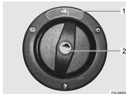
Bild 34 Lock för påfyllningsöppningen för dricksvatten (alternativ)
