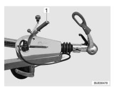
Fig. 16 Handbrake
