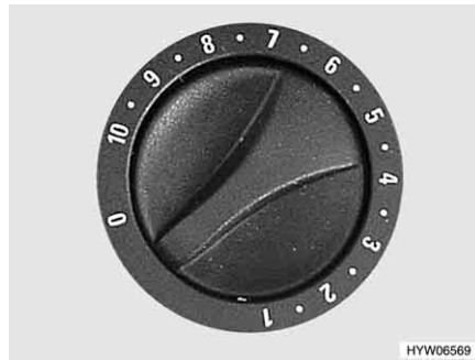
Afb. 108 Draairegelaar aan de verwarming
