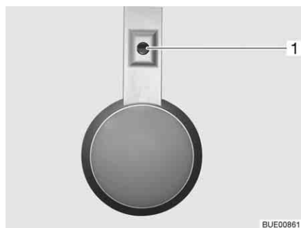
Afb. 39 Toiletruimteverlichting, lichtschakelaar direct bij de lamp
