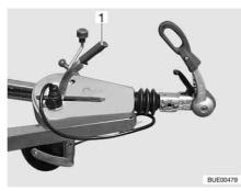
Fig. 17 Handbrake
