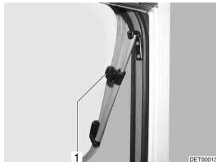
Bild 46 Överkantshängt fönster med vridspärrar, öppet
