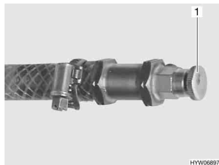
Billede 198 Udluftningsventil varmtvandsvarmeovn
