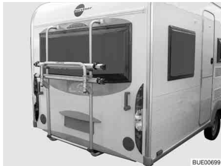
Billede 11 Cykelholder på hækvæggen
