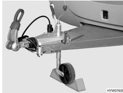
Billede 211 Sikring af støttehjulet
