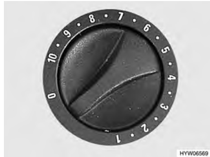
Bild 116 Vridregulator till värmesystemet
