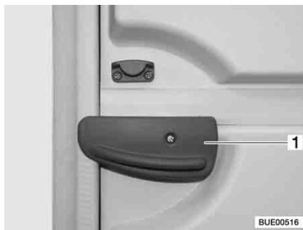
Bild 26 Verriegelungshebel am Türunterteil
