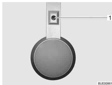
Bild 45 Toilettenraumbeleuchtung, Lichtschalter direkt an der Leuchte
