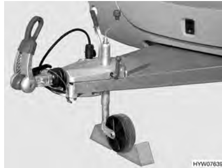
Billede 216 Sikring af støttehjulet
