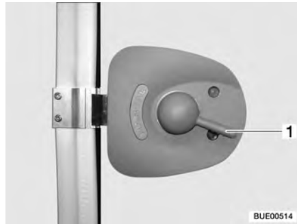
Billede 24 Indgangsdørens lås, indvendigt, åben
