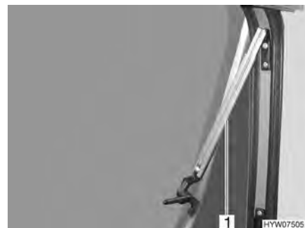
Bild 56 Överkantshängt fönster med automatik-spärrar, öppet
