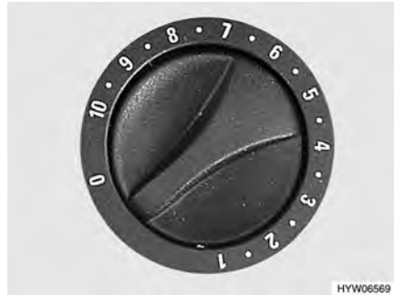
Bild 114 Vridregulator till värmesystemet
