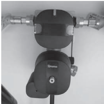
Abb. 77: Gasversorgung (mit Eis-Ex und Fernanzeige)
