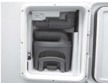
Abb. 47: Fäkalientank mit Spülwasser-Einfüllstutzen
