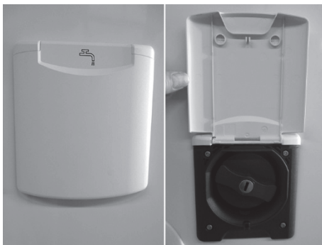
Abb. 27: Frischwassereinfüllstutzen
