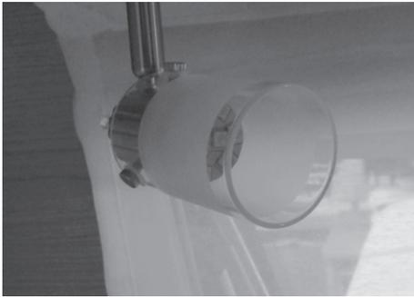
En el interior, encima del grupo de asientos y en la zona dormitorio hay un sistema de barra de iluminación con focos LED de 12 V giratorios, oscilantes y móviles, que permiten una buena iluminación de las áreas (para el manejo véase el → apartado "Configurar la iluminación").
