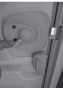
*Fig. 22: Palanca abajo, abrir la puerta*
