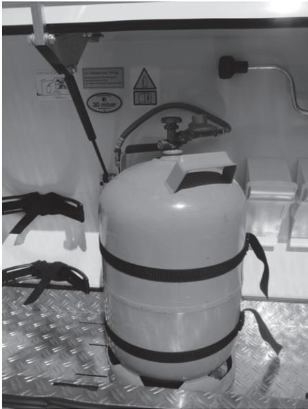
Fig. 75: Válvula reductora de presión
