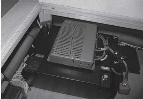
Fig. 65: Cubierta de batería con unidad de mando para Mover (opcional)
