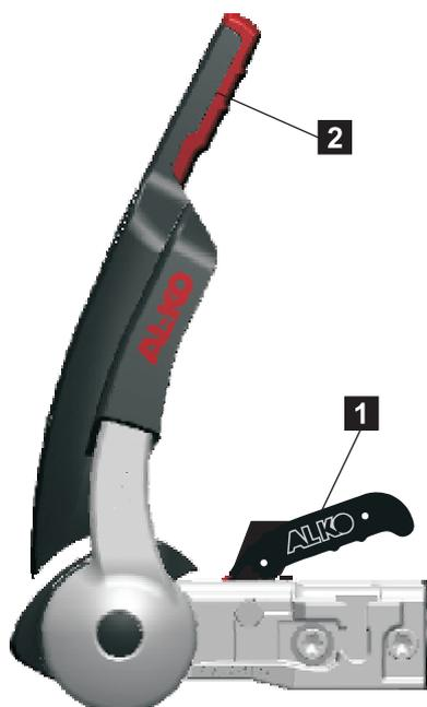
Fig. 5: Enganche para bola de tracción abierto
