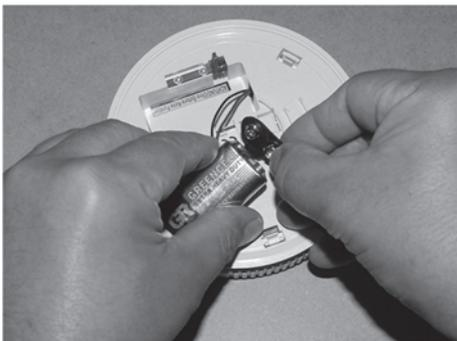
Fig. 109: Reemplazar la pila monobloc
