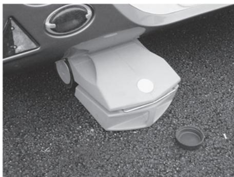
Fig. 99: Depósito de aguas residuales sobre ruedas
