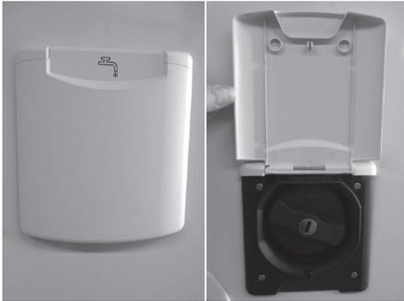
Fig. 94: Tubo de carga de agua limpia
