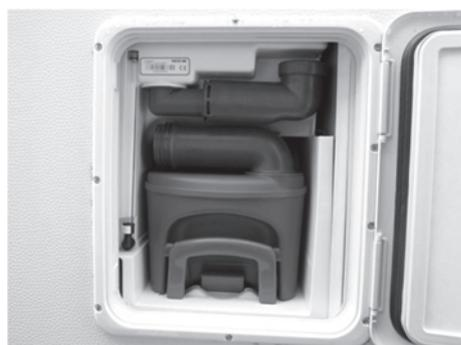
*Fig. 47: Depósito para materiales fecales con tubo de carga-de agua para soltar*
