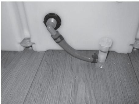
Fig. 87: Válvula de vaciado, ejemplo
