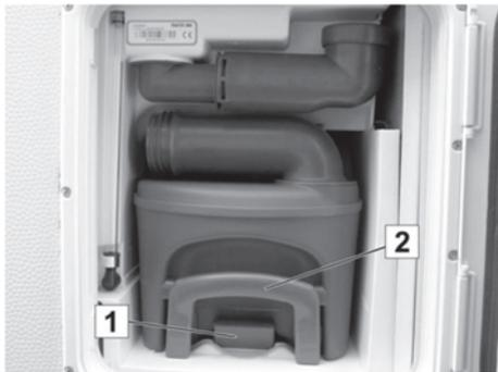
Fig. 140: Depósito de materias fecales en el pozo de eliminación
