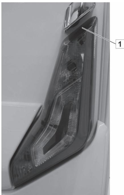
Fig. 167: Soltar la lámpara híbrida
