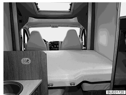
Bild 141 Hubbett, ganz abgesenkt (modellabhängig)
