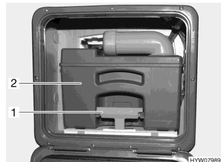
Fig. 269 Serbatoio fecale (esempio)
