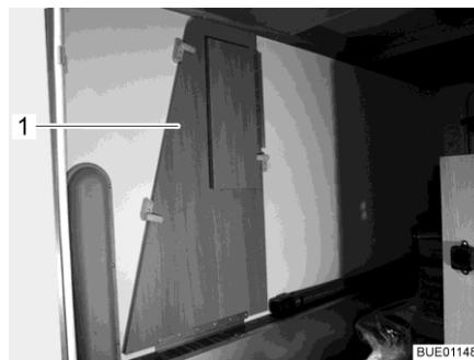
Fig. 13 Allargamento letto nel garage di coda
