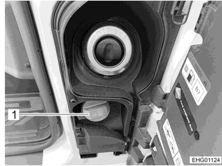
Fig. 45 Bocchettone di riempimento per AdBlue® (Ford)
