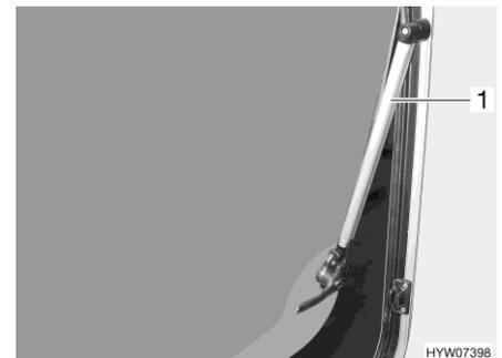
Fig. 99 Finestra apribile con deflettore automatico
