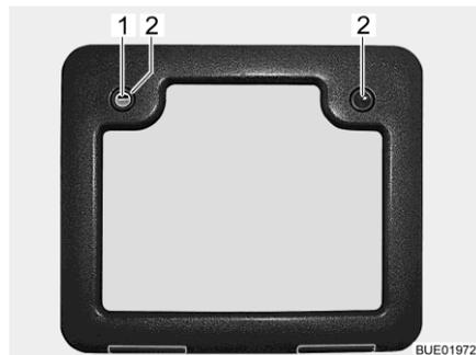
Fig. 268 Sportello per il serbatoio fecale (alternativa)
