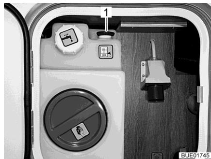
Fig. 254 Serbatoio dell'acqua (unità di servizio)
