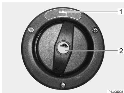
Fig. 248 Bocchettone di riempimento dell'acqua potabile nella parete laterale del veicolo
