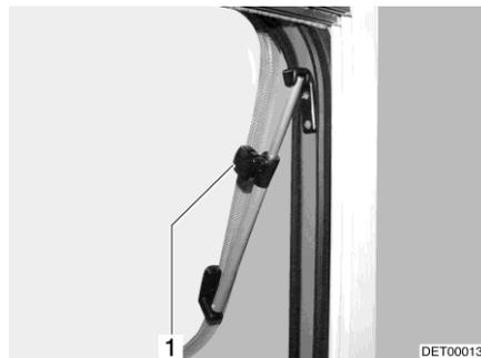
Fig. 98 Finestra apribile con deflettore a rotazione
