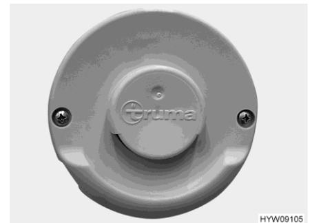
Fig. 223 Camino da parete (riscaldamento ad aria calda)
