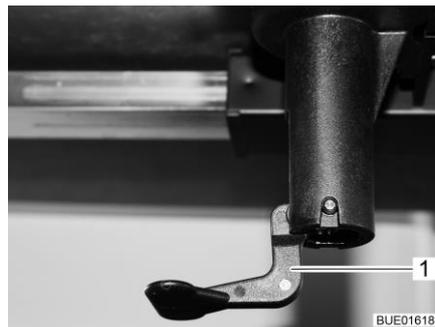
Fig. 124 Sbloccaggio del piano del tavolo
