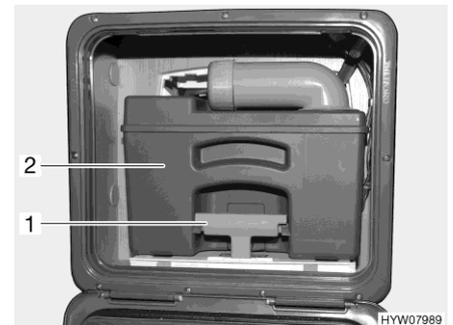
Fig. 281 Serbatoio fecale (esempio)
