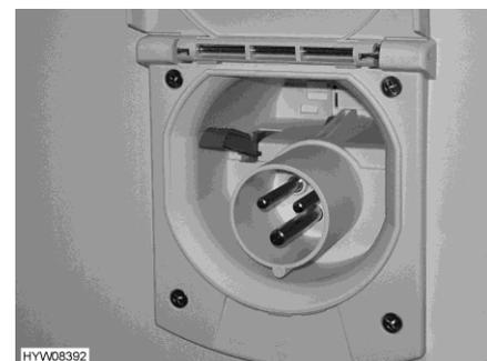
Fig. 195 Collegamento a 230 V al veicolo (senza unità di servizio)
