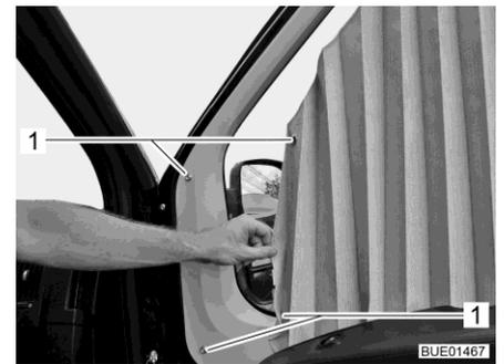
Fig. 107 Fissaggio tendina plissettata
