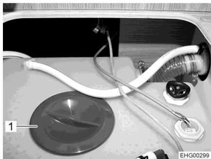
Fig. 283 Apertura per la pulizia sul serbatoio dell'acqua
