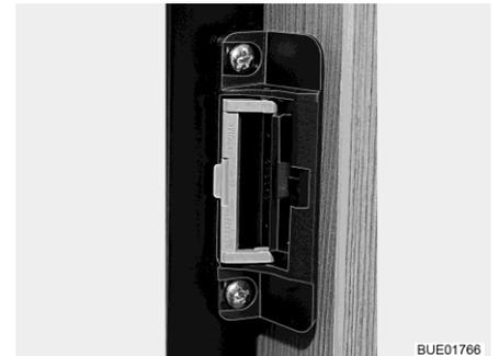
Fig. 246 Dispositivo di chiusura in posizione di ricircolo d'aria
