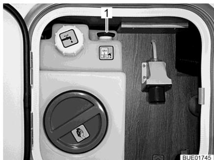
Fig. 256 Serbatoio dell'acqua (unità di servizio)
