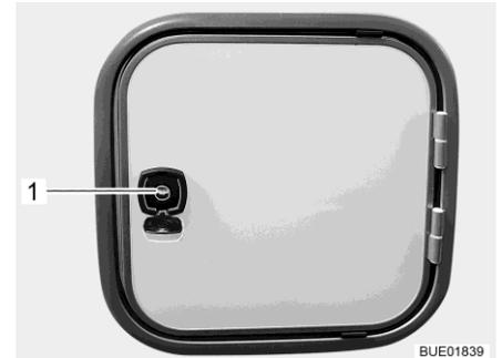
Fig. 279 Sportello per il serbatoio fecale (alternativa)
