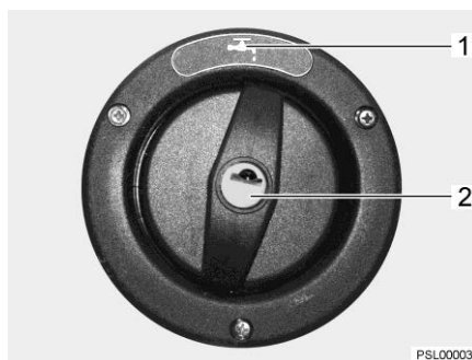
Fig. 248 Tubo de llenado de agua potable en la pared lateral del vehículo
