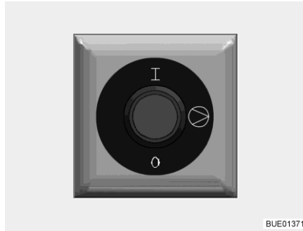
Fig. 220 Conmutador de mando de la bomba de circulación adicional
