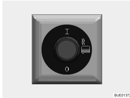
Fig. 264 Interruptor para calefacción de aguas residuales
