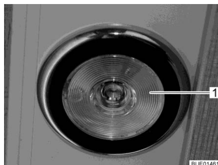
Fig. 79 Lámpara empotrada, interruptor de luz dentro de la lámpara
