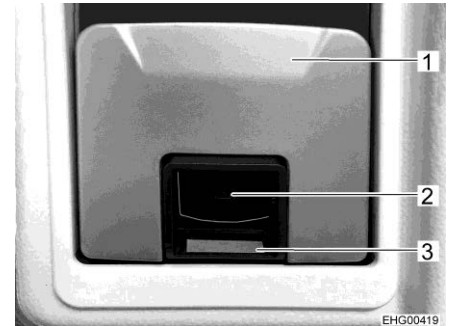
Fig. 57 Cerradura de la puerta, variante (puerta de entrada en el Interior)
