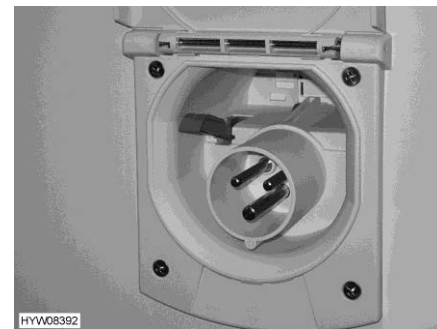
Fig. 195 Conexión de 230 V en el vehículo (sin unidad de servicio)
