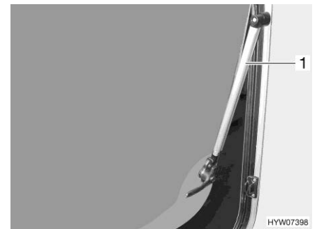
Fig. 99 Ventana abatible con soporte automático
