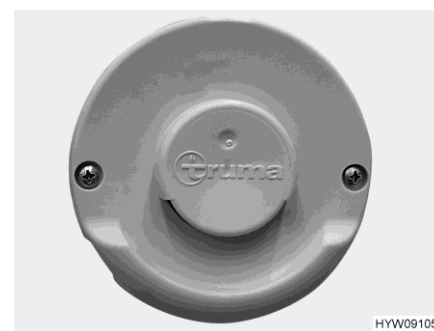
Fig. 223 Tubo de chimenea en la pared (calefacción de aire caliente)
