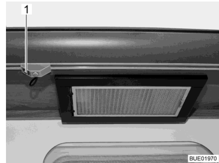
Fig. 234 Campana sin ventilación
