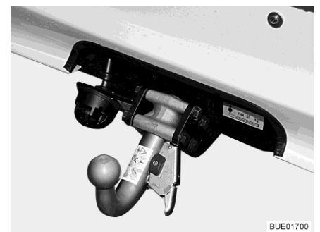
Fig. 7 Acoplamiento de remolque, desmontable
