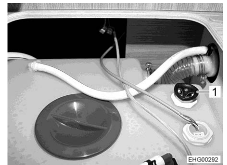
Fig. 255 Depósito de agua (alternativa)
