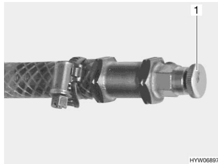
Fig. 287 Válvula de purga de la calefacción de agua caliente
