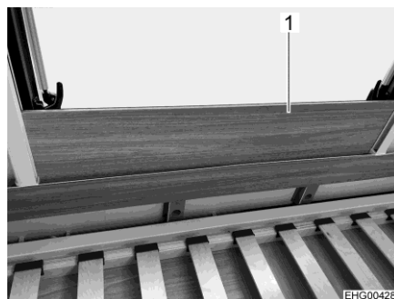
Fig. 176 Protección contra caídas (ventana)
