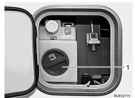
Fig. 284 Orificio de limpieza del depósito de agua (unidad de servicio)
