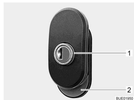
Fig. 65 Cerradura de la trampilla, desbloqueada
