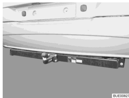
Fig. 6 Acoplamiento de remolque, rígido
