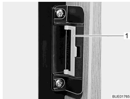
Fig. 245 Dispositivo de cierre en posición normal
