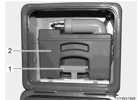
Fig. 269 Depósito de aguas fecales (ejemplo)
