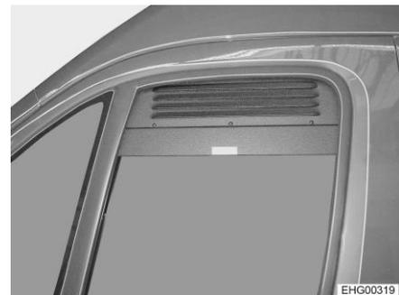
Fig. 62 Grille d'aération forcée (fenêtre latérale fermée)
