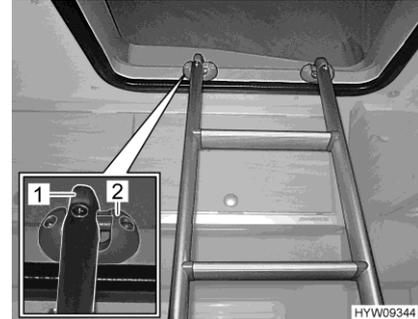
Fig. 56 Échelle de montée (accrochée)
