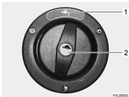
Fig. 87 Couvercle de fermeture pour bec de remplissage d'eau potable
