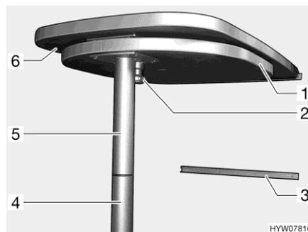
Fig. 32 Table suspendue avec pied d'appui divisible
