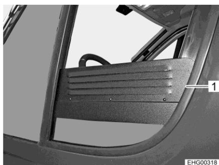
Fig. 61 Griglia di aerazione forzata (finestrino abbassato)
