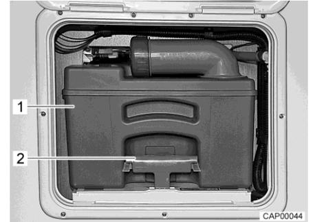
Fig. 100 Serbatoio fecale
