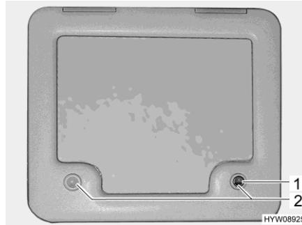
Fig. 99 Sportello per il serbatoio fecale
