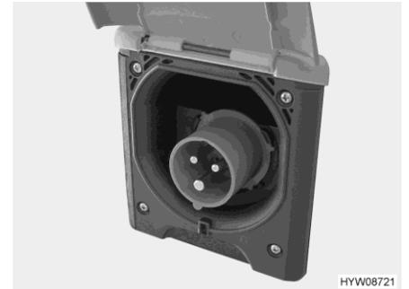
Fig. 72 Collegamento a 230 V al veicolo (presa CEE)
