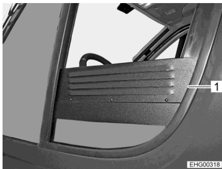
Kuva 61 Pakkotuuletusritilä (sivuikkuna auki)
