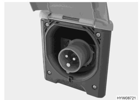
Bild 72 230-V-Anschluss am Fahrzeug (CEE-Steckdose)
