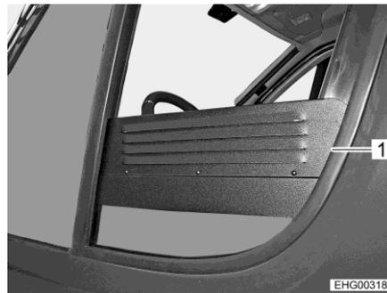
Bild 61 Zwangsbelüftungsgitter (Seitenfenster geöffnet)
