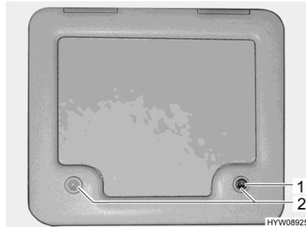
Bild 99 Klappe für den Fäkalientank
