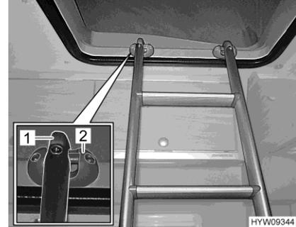
Bild 56 Aufstiegsleiter (eingehängt) (Beispielbild)
