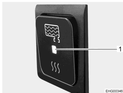
Bild 95 Ein-/Aus-Schalter, eingeschaltet
