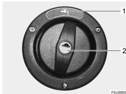
Bild 87 Verschlussdeckel für Trinkwasser-Einfüllstutzen
