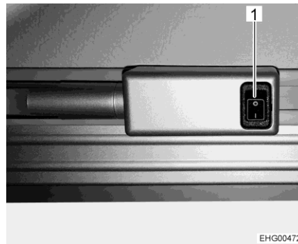
Afb. 17 Schakelaar voor LED-lichtbalken
