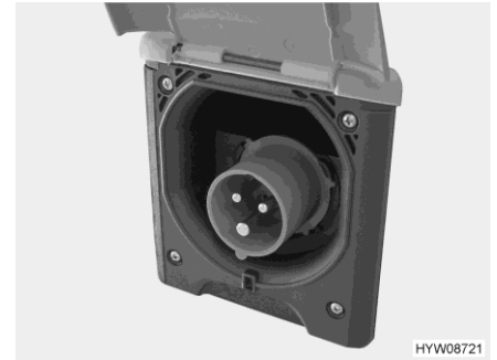
Afb. 47 230-V-aansluiting op het voertuig (CEE-contactdoos)
