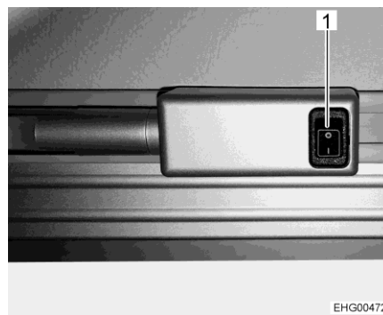
Bild 17 Omkopplare för LED-ljusskenor
