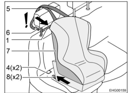
Fig. 4 Fissaggio con Isofix
