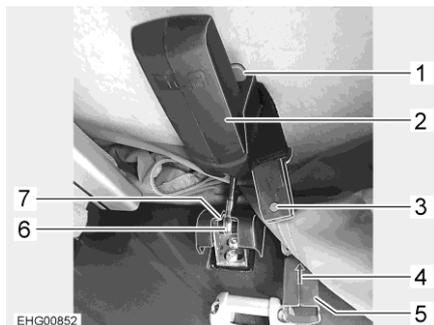
Fig. 37 Bloccaggio, tetto a soffietto posteriore (C 530)
