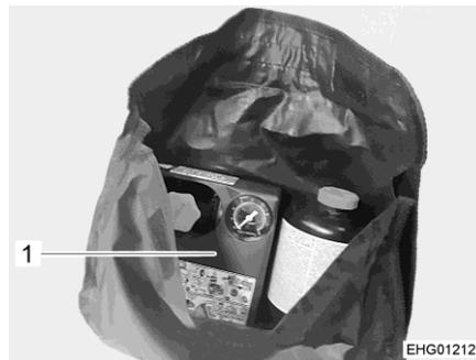
Fig. 73 Kit di riparazione pneumatici
