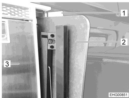
Fig. 15 Tavolo (fissato nel vano) (C 530)
