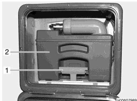
Fig. 69 Serbatoio fecale (esempio)
