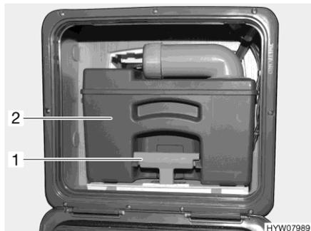
Fig. 69 Depósito de aguas fecales (ejemplo)
