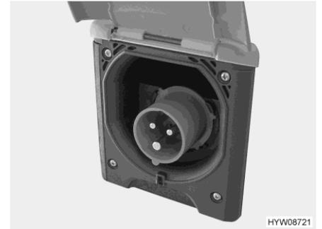
Fig. 47 Conexión de 230 V en el vehículo (caja de enchufe CEE)
