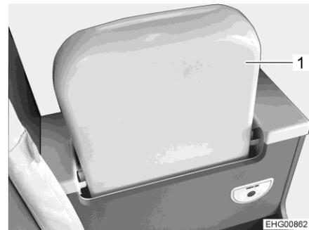
Bild 67 Waschbecken, nach oben geklappt
