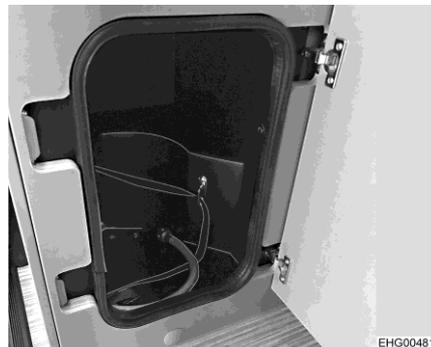
Bild 43 Gaskasten
