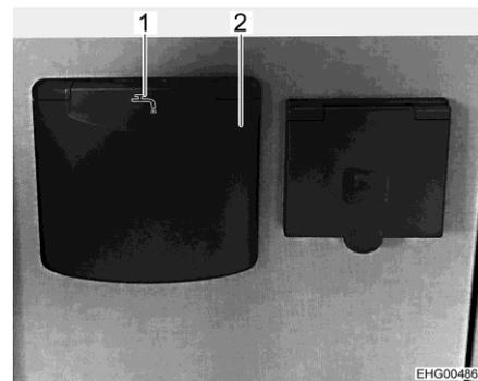
Bild 63 Zugangsklappe Trinkwasser-Einfüllstutzen
