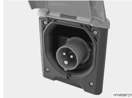
Bild 47 230-V-Anschluss am Fahrzeug (CEE-Steckdose)
