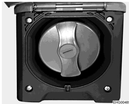
Bild 62 Verschlussdeckel für Trinkwasser-Einfüllstutzen
