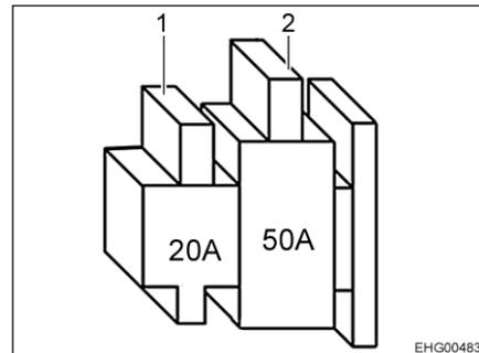
Bild 50 Sicherungen für Starterbatterie und Ladebooster
