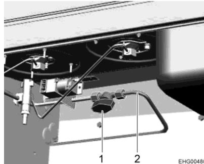
Bild 42 Gasabsperrventil
