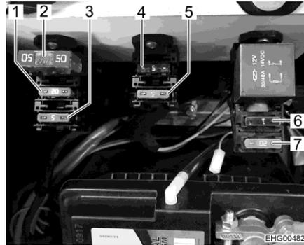
Bild 49 Sicherungen für Wohnraumbatterie und weitere Geräte
