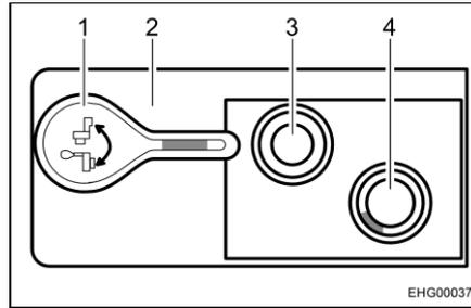
Bild 54 Ablassventil, geschlossen
