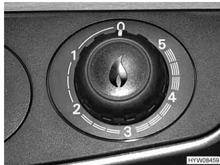
Billede 144 Drejeregulator på varmluftvarmeovnen
