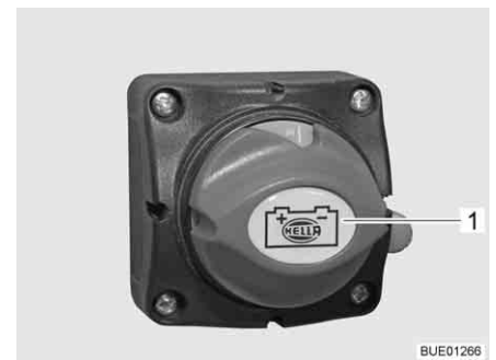
Billede 115 Batterihovedafbryder, stilling "ON"
