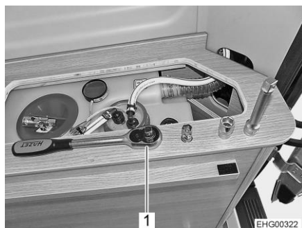
Fig. 101 Accès à la fixation de l'unité de feux arrière
