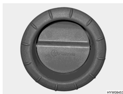
Fig. 71 Buse de sortie d'air (chauffage à air chaud)
