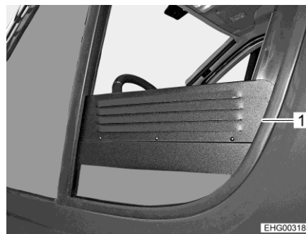
Fig. 46 Grille d'aération forcée (fenêtre latérale ouverte)
