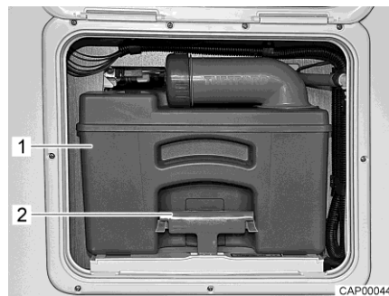
Fig. 98 Réservoir pour matières fécales
