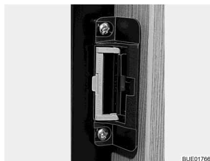
Fig. 82 Dispositif de fermeture en position de ventilation
