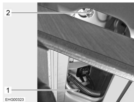
Fig. 102 Fixation de l'unité de feux arrière
