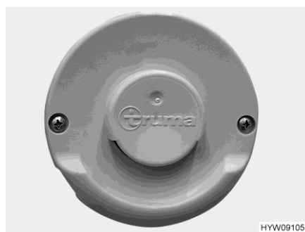
Fig. 77 Cheminée murale (chauffage à air chaud)
