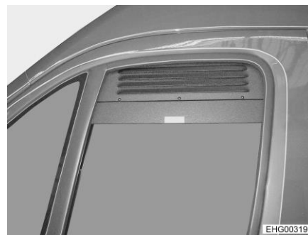
Fig. 47 Grille d'aération forcée (fenêtre latérale fermée)
