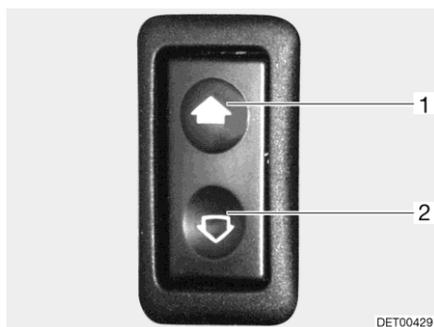
Fig. 25 Interrupteur pour lève-vitre électrique
