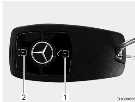
Fig. 47 Télécommande du verrouillage centralisé
