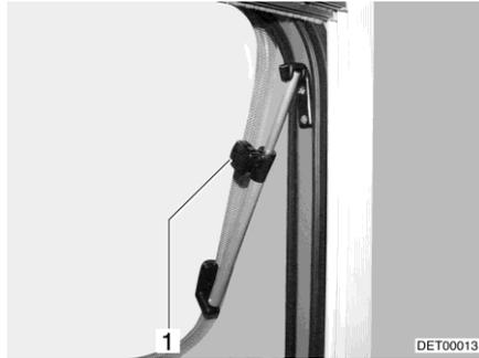
Fig. 80 Fenêtre projetante avec bras pivotant
