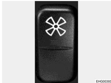
Fig. 130 Commutateur à bascule ventilateur d'appoint
