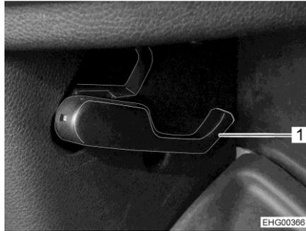
Fig. 35 Levier de déverrouillage capot moteur (dans le véhicule)
