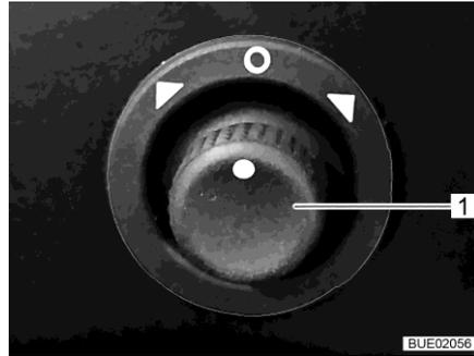
Fig. 27 Interrupteur réglage des rétroviseurs extérieurs
