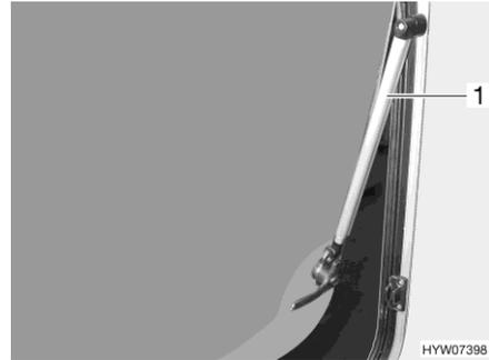
Fig. 81 Fenêtre projetante avec bras automatique
