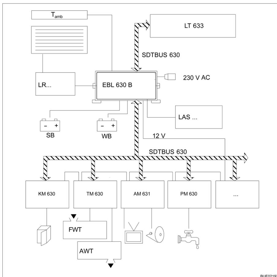
Fig. 119 Schéma fonctionnel alimentation en énergie EBL 630
