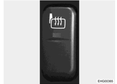
Fig. 28 Interrupteur du chauffage des rétroviseurs extérieurs
