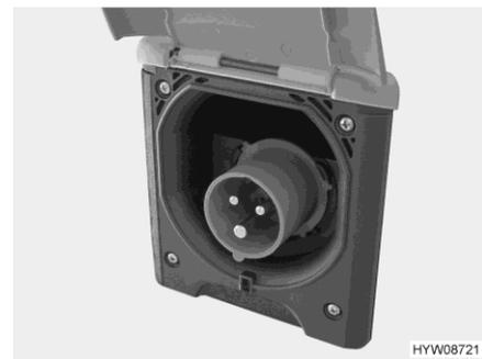
Fig. 111 Raccordement 230 V sur le véhicule (prise de courant CEE)
