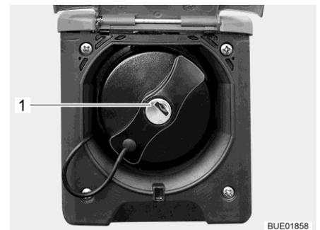
Fig. 39 Couvercle de fermeture du bec de remplissage du carburant
