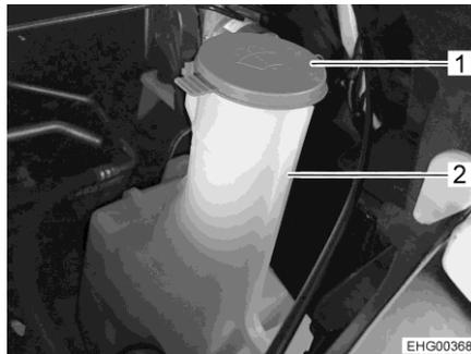
Fig. 37 Bec de remplissage réservoir pour liquide d'essuie-glace
