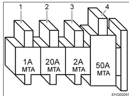
Fig. 114 Fusibles (batterie de cellule avec booster de charge)
