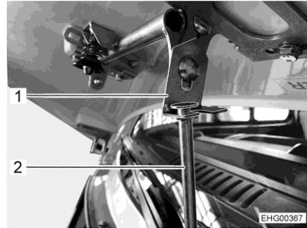
Fig. 36 Support capot moteur
