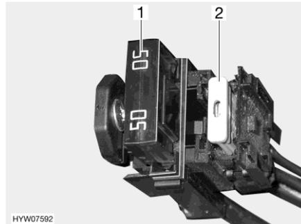
Fig. 113 Fusibles de la batterie de cellule
