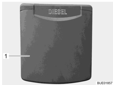
Fig. 38 Portillon extérieur bec de remplissage du carburant
