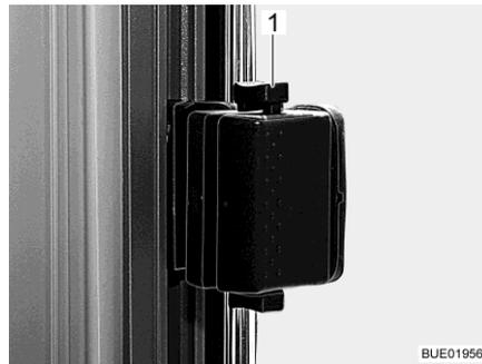
Fig. 84 Fenêtre coulissante, verrouillée
