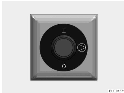
Fig. 129 Commutateur de commande du circulateur supplémentaire
