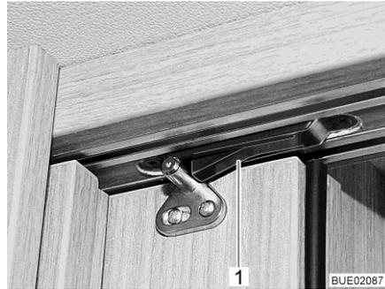
Fig. 9 Cran d'arrêt à ressort
