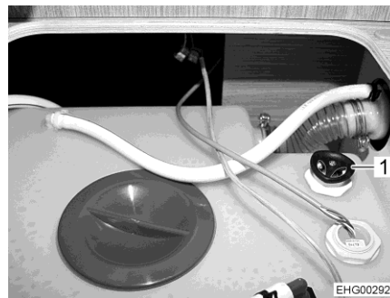
Fig. 280 Réservoir d'eau (alternative)
