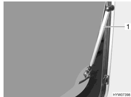
Fig. 100 Fenêtre projetante avec bras automatique
