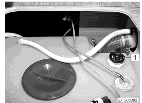
Fig. 278 Réservoir d'eau (alternative)
