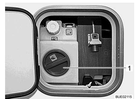
Fig. 307 Ouverture de nettoyage du réservoir d'eau (unité de service)
