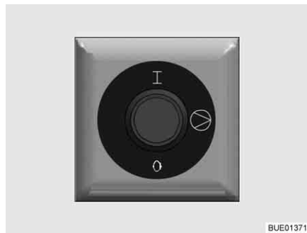
Fig. 204 Interruttore di comando pompa di circolazione aggiuntiva
