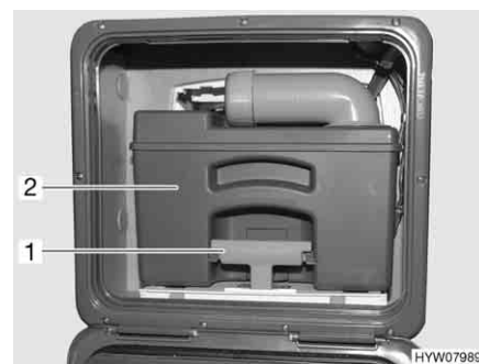
Fig. 257 Serbatoio fecale (esempio)
