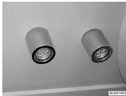
Fig. 68 Lampada a soffitto, separata dall'interruttore (esempio)
