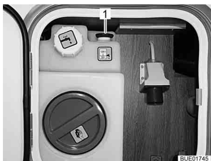
Fig. 247 Serbatoio dell'acqua (unità di alimentazione centrale)
