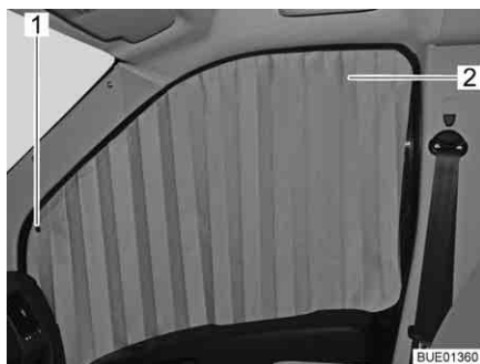
Bild 88 Plisséförhänge vid passagerarfönster
