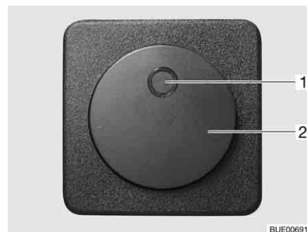
Bild 210 Brytare för elektrisk golvvärme
