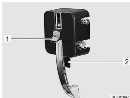
Bild 44 Dörrlås ingångsdörr, insida
