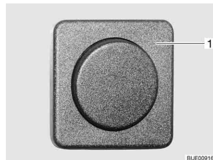
Bild 69 Brytare, frånskild från lampan (exempel)
