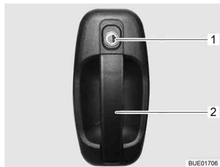
Bild 46 Dörrlås ingångsdörr, utsida
