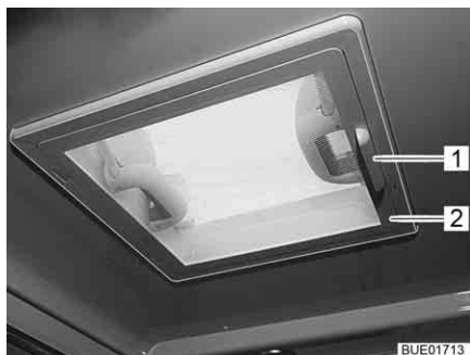
Bild 92 Taklucka med snäplås
