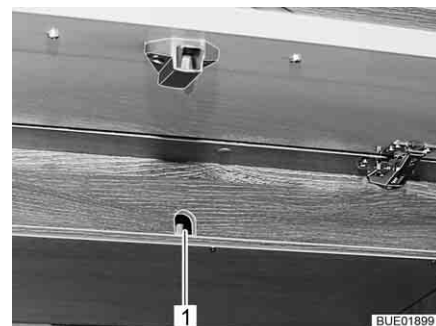
Bild 128 Åtkomst till drivenheten (alternativ)
