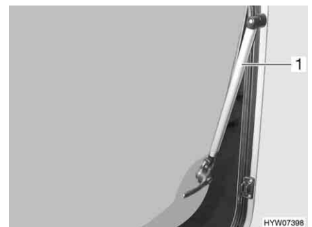
Bild 81 Överkantshängt fönster med automatik-spärr
