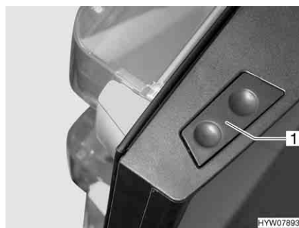
Kuva 232 Jääkaapin oven lukituksen avauspainike (Dometic 8-sarja)
