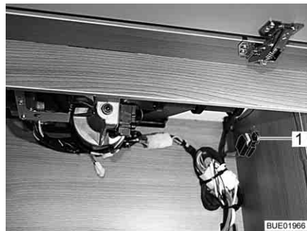
Kuva 183 Ylös nostettavan vuoteen sulake takana
