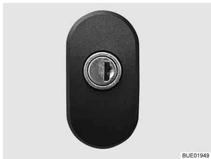
Kuva 54 Luukun lukko, lukossa
