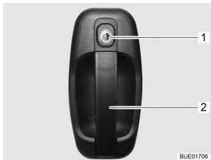
Kuva 46 Sisäänkäyntioven lukko, ulkoa
