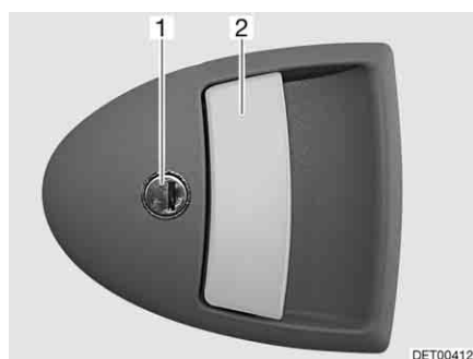
Kuva 45 Sisäänkäyntioven lukko, ulkoa
