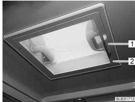
Kuva 92 Kattoluukku, jossa on napsautuslukko
