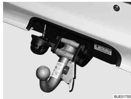
Kuva 9 Perävaunun vetokoukku, irrottava
