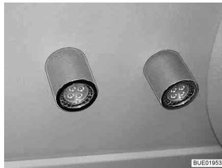
Kuva 68 Kattovalaisin, erillään kytkimestä (esimerkki)
