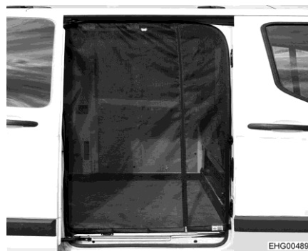
Fig. 10 Protección contra insectos, puerta corredera
