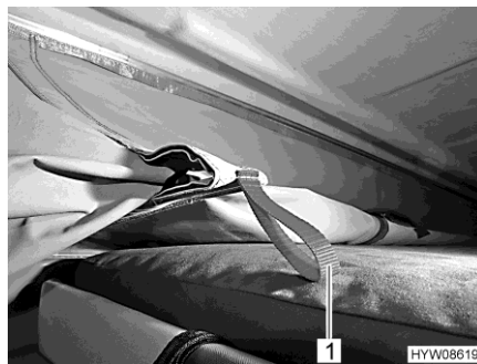
Fig. 33 Dispositivo de recogida
