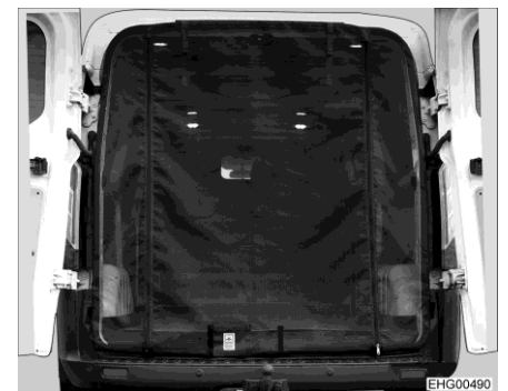
Fig. 11 Protección contra insectos, parte trasera
