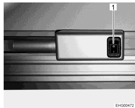
Afb. 17 Schakelaar voor LED-lichtbalken
