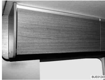
Fig. 39 Trampillas de muebles con desbloqueo por presión (ejemplo)
