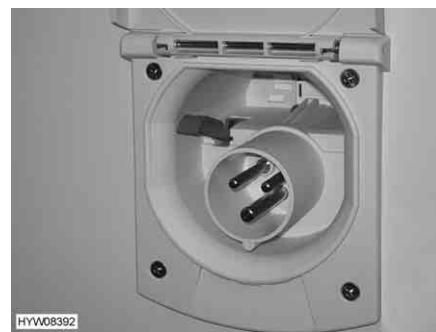
Fig. 110 Conexión de 230 V en el vehículo
