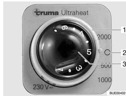
Fig. 129 Elemento de mando de la calefacción adicional eléctrica Ultraheat
