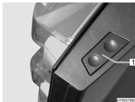
Fig. 142 Touche de déverrouillage de la porte du réfrigérateur (Dometic Série 8)
