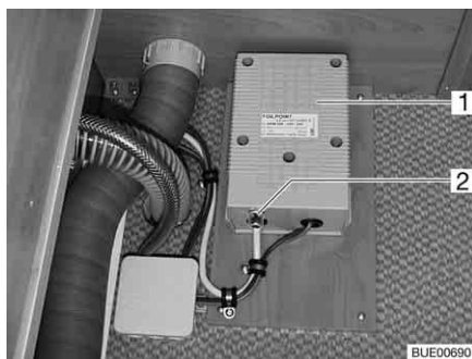
Fig. 117 Transformateur du chauffage électrique du plancher
