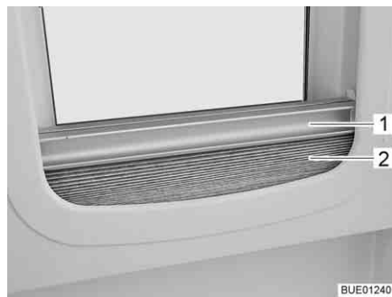
Fig. 26 Dispositif occultant plissé
