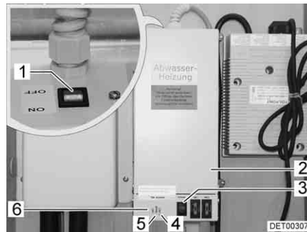
Fig. 116 Transformateur avec régulateur
