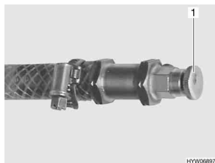
Fig. 196 Soupape de purge pour le chauffage à eau chaude
