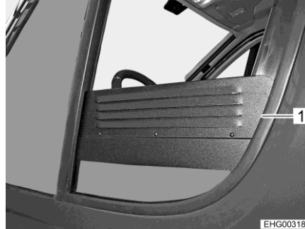
Kuva 78 Pakkotuuletusritilä (sivuikkuna auki)
