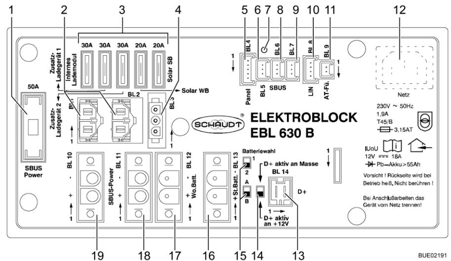
Fig. 108 Transformer/rectifier (EBL 630)
