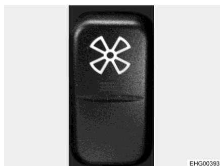
Fig. 130 Auxiliary fan rocker switch
