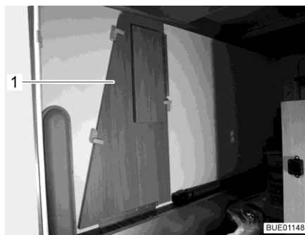
Fig. 11 Allargamento letto nel garage di coda
