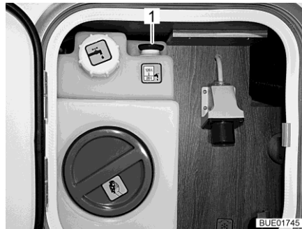
Fig. 175 Serbatoio dell'acqua (unità di servizio)
