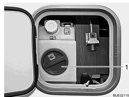
Fig. 197 Apertura per la pulizia sul serbatoio dell'acqua (unità di servizio)
