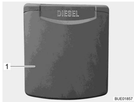
Kuva 44 Polttoaineen täyttöaukon ulkoluukku
