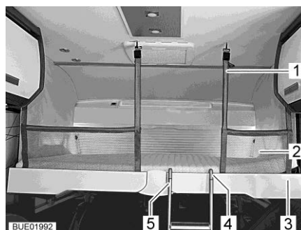
Billede 121 Hejseseng med opspændt sikkerhedsnet
