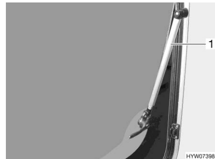
Billede 97 Ventilationsrude med automatiske udskydere
