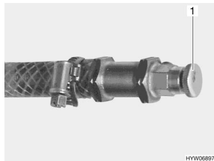
Billede 215 Udluftningsventil varmtvandsvarmeovn
