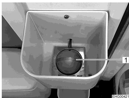
Bild 85 Aktive Dockingstation an der Eingangstür
