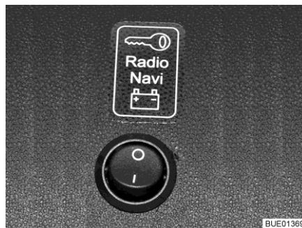
Bild 202 Wahlschalter für Stromversorgung
