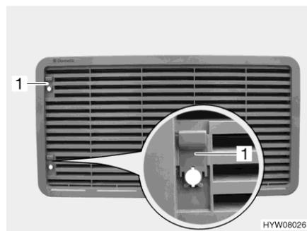
Bild 261 Kühlschrank-Lüftungsgitter (mit Schieber)
