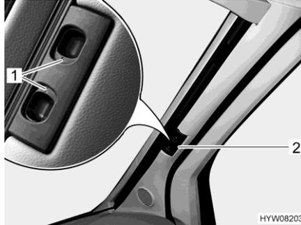
Bild 40 faltverdunklung für die Frontscheibe
