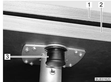
Bild 129 Ausschwenkbare Tischverlängerung
