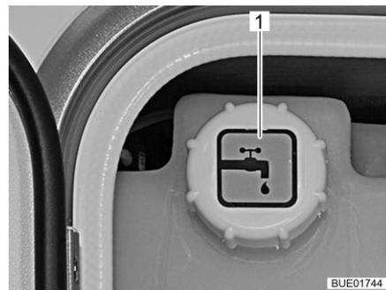
Bild 272 Trinkwassereinfüllstutzen in Service-Unit (Alternative)
