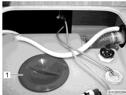
Bild 306 Reinigungsöffnung Wassertank
