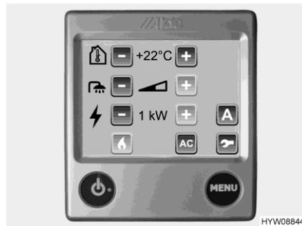
Bild 235 Einstellmenü (Bedieneinheit)
