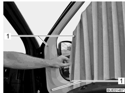
Bild 108 Befestigung Faltvorhang
