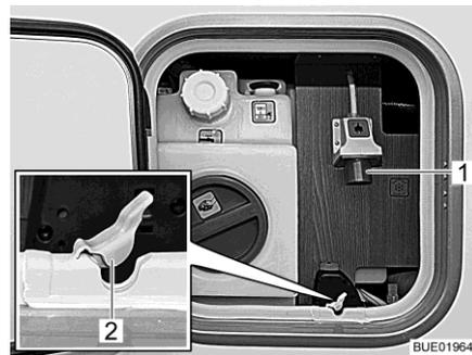
Bild 207 230-V-Anschluss am Fahrzeug (mit Service Unit)
