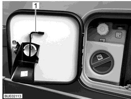
Bild 286 Serviceklappe mit Vierkantschlüssel
