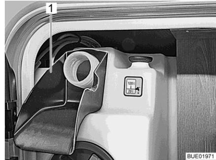
Bild 276 Einfüllhilfe
