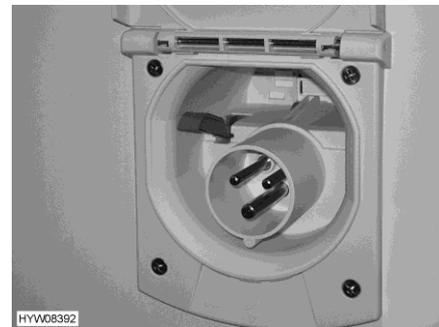
Bild 208 230-V-Anschluss am Fahrzeug (ohne Service Unit)
