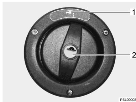
Bild 271 Trinkwasser-Einfüllstutzen in Seitenwand des Fahrzeugs
