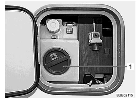
Bild 307 Reinigungsöffnung Wassertank (Service-Unit)
