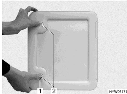
Bild 301 Klappe für den Fäkalientank
