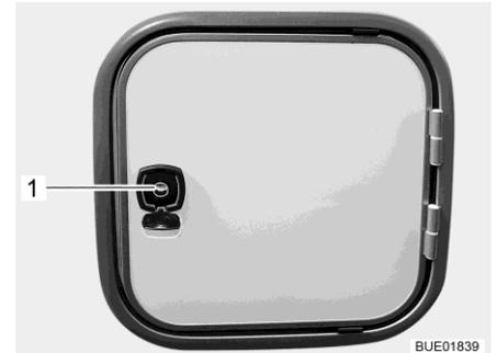
Bild 302 Klappe für den Fäkalientank (Alternative)
