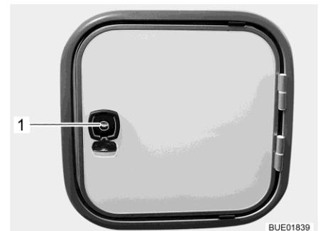
Bild 290 Klappe für Fäkalientank (Alternative)
