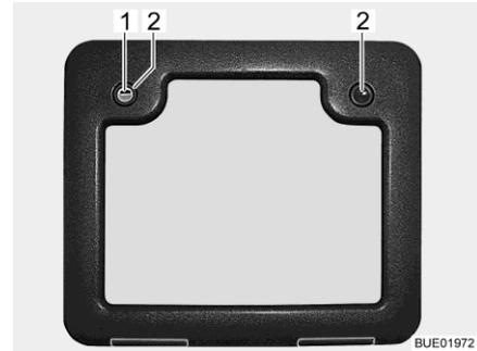
Bild 60 Druckschloss Serviceklappe (Alternative)
