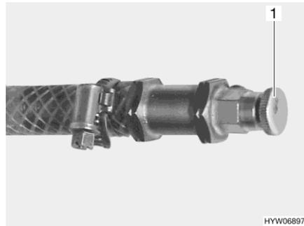
Bild 310 Entlüftungsventil Warmwasser-Heizung
