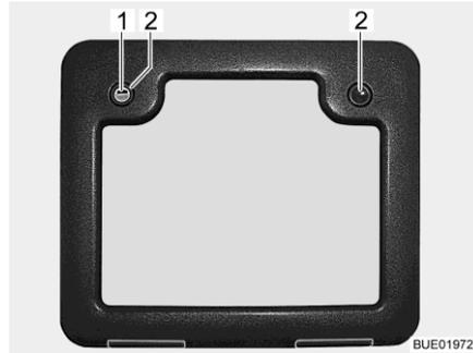
Bild 291 Klappe für Fäkalientank
