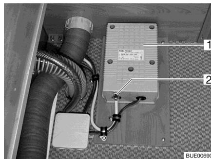
Bild 244 Trafo für elektrische Fußbodenerwärmung
