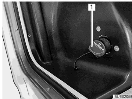
Bild 42 Einfüllstutzen für AdBlue®
