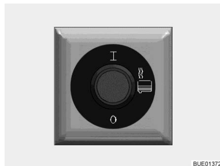
Bild 150 Schalter für Abwasserheizung
