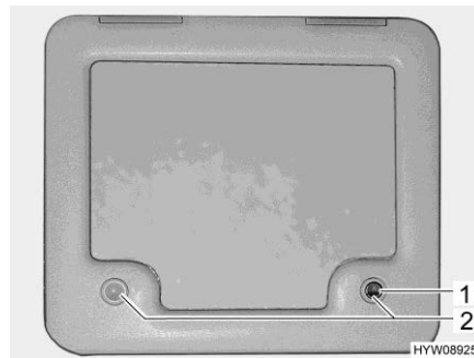
Bild 160 Klappe für den Fäkalientank
