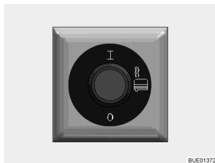
Bild 174 Schalter für Abwasserheizung
