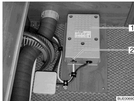
Bild 147 Trafo für elektrische Fußbodenerwärmung
