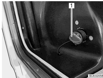
Bild 25 Einfüllstutzen für AdBlue®
