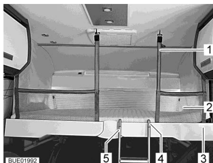
Bild 121 Hubbett mit aufgespanntem Sicherungsnetz
