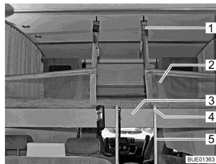
Bild 123 Hubbett mit aufgespanntem Sicherungsnetz
