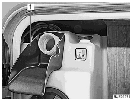
Fig. 193 Aide au remplissage
