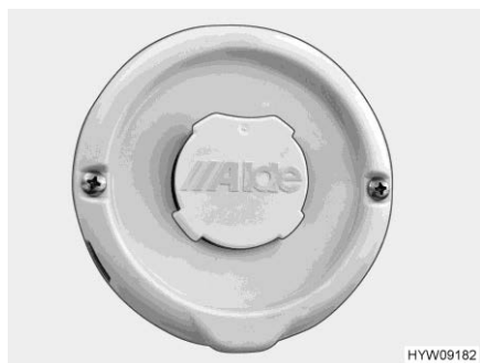
Fig. 166 Cheminée murale (chauffage à eau chaude)
