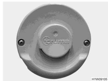
Bild 232 Väggekamin (varmluft-värme- system)
