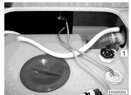
Fig. 256 Réservoir d'eau (alternative)
