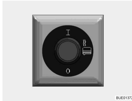
Fig. 265 Interrupteur pour le chauffage des eaux usées
