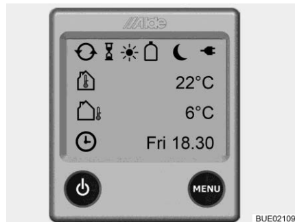
Fig. 213 Écran de démarrage (unité de commande)
