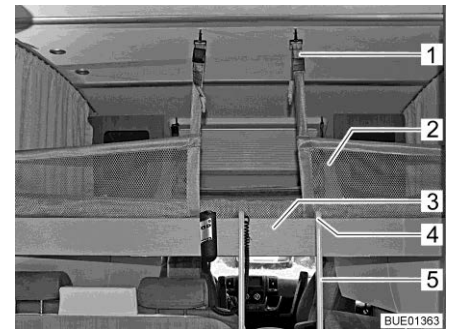
Fig. 141 Lit escamotable avec filet de sécurité tendu
