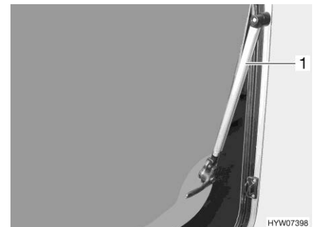
Billede 112 Ventilationsrude med automatiske udskydere
