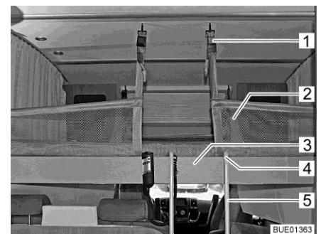
Billede 141 Hejseseng med opspændt sikkerhedsnet
