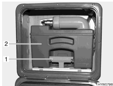
Billede 278 Toilettank (eksempel)
