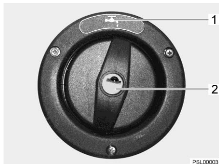
Billede 81 Dæksel til drikkevands-påfyldningsstuds
