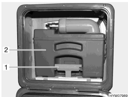
Billede 269 Toilettank (eksempel)
