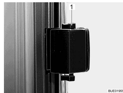
Billede 116 Skydevindue, oplåst
