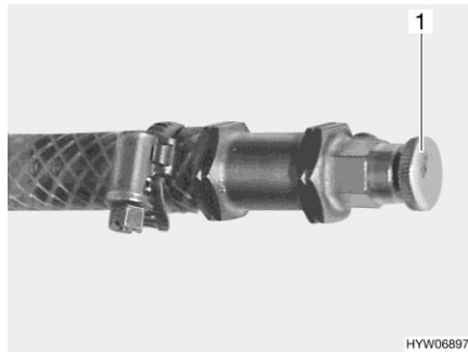
Billede 284 Udluftningsventil varmtvandsvarmeovn
