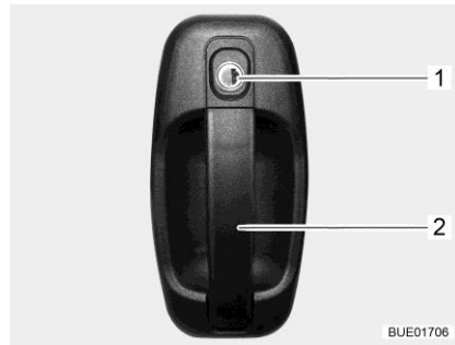
Bild 33 Dörrlås (ingångsdörr utsida)
